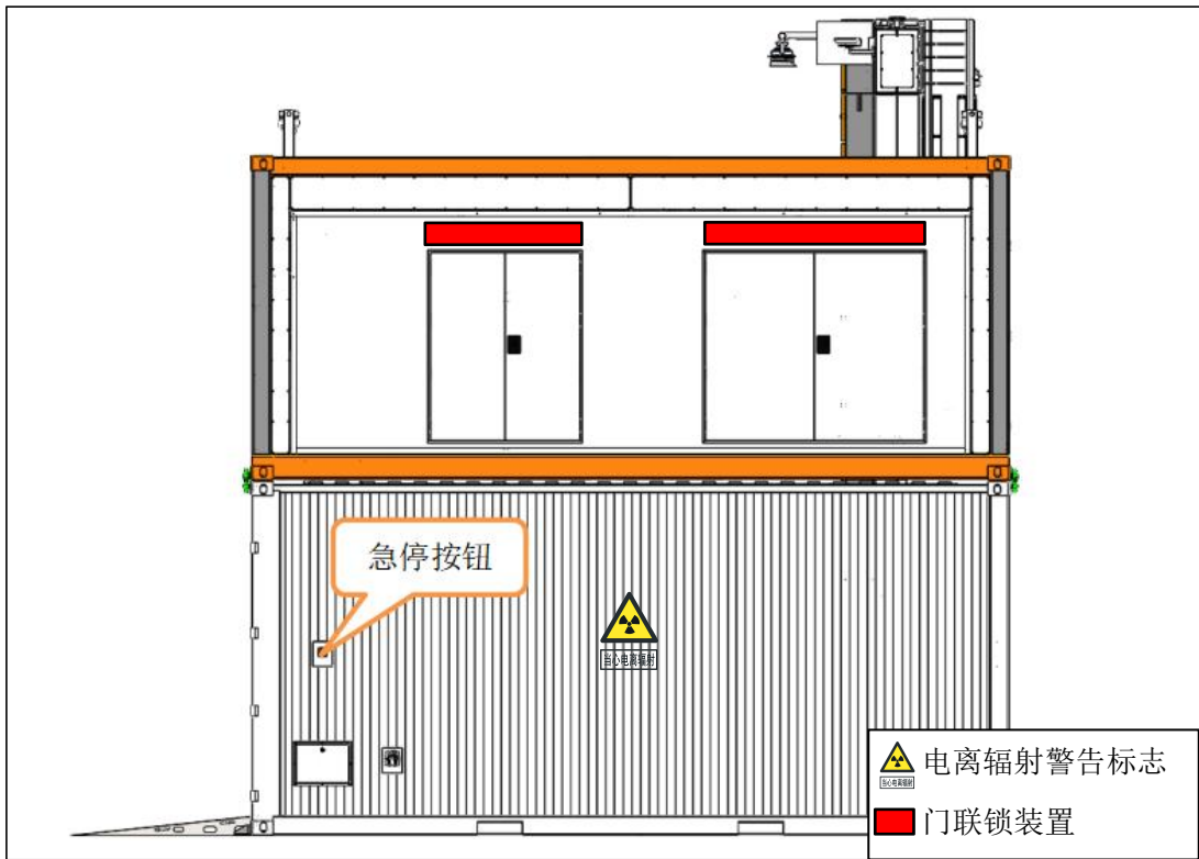
图 10.1-8 本项目辐射安全和防护设施图（侧面 1）
