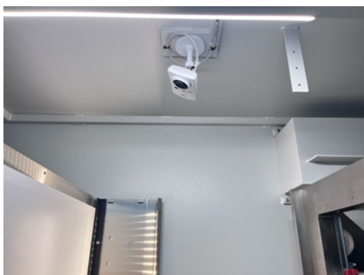
图 3-8 工业 CT 检测装置内部摄像头
