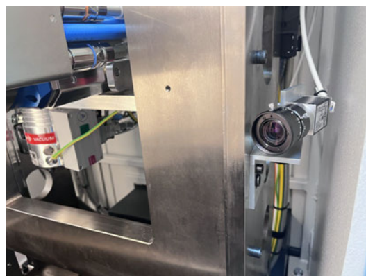
图 3-8 工业 CT 检测装置内部摄像头
