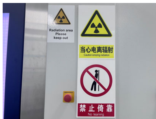
图 3-5 工业 CT 检测装置外警示标志和紧急停机按钮
