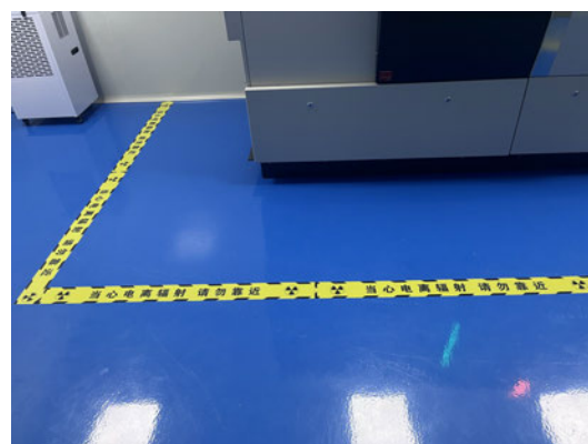
图 3-4 工业 CT 检测装置周围警戒线
