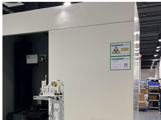
图 3-19 双立柱离线 CT 铅房外警示标志
