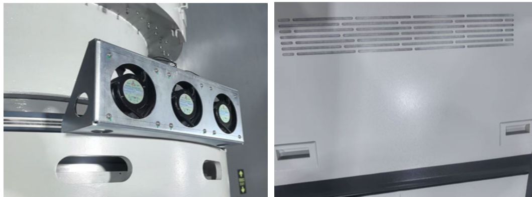
图 3-32 安检 CT（620）外部通风口
