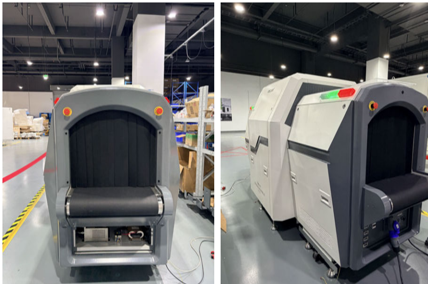
图 3-31 安检 CT（620）外紧急停机按钮
