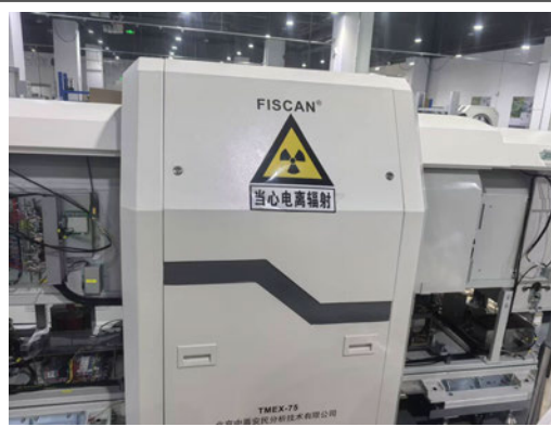
图 3-30 安检 CT（620）外警示标志
