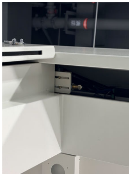
图 3-26 双立柱离线 CT 铅房门-机安全联锁装置
