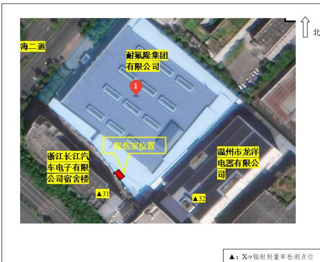
图 6-3 探伤室周围 X-γ辐射剂量率检测点位示意图
