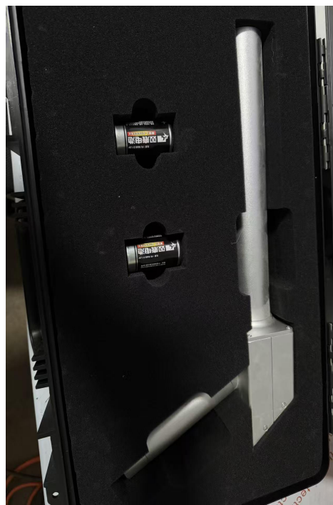
图 3-17 1 台 JC-IDNA-25 型辐射巡测仪
