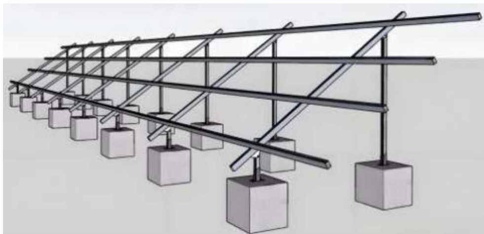
图 2.4-1 抱箍撑杆定位示意图
