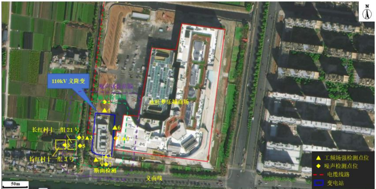
图 A3-1 义盛 110 千伏输变电工程工频场强检测工频场强检测点位示意图
