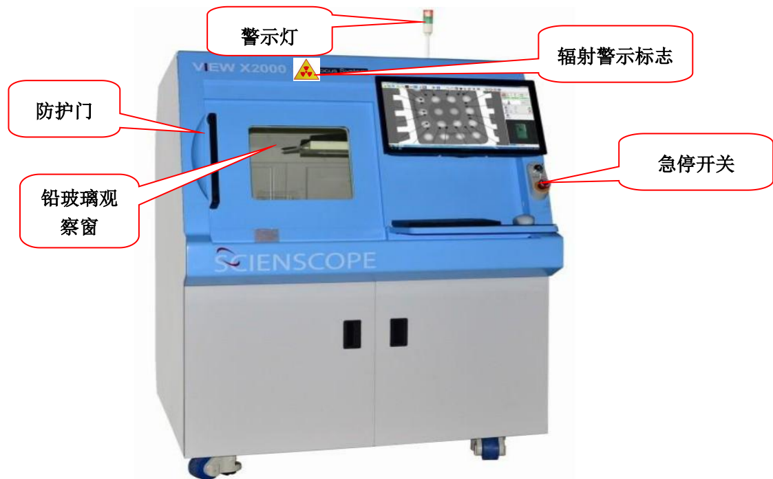
图10.1-3 Scienscope View X2000型工业X射线检测仪安全防护设施示意图（本次扩建）
