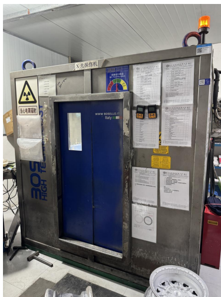
图 2-1 XRG 160-.64CI 型工业 X 射线数字实时成像检测装置外观图
